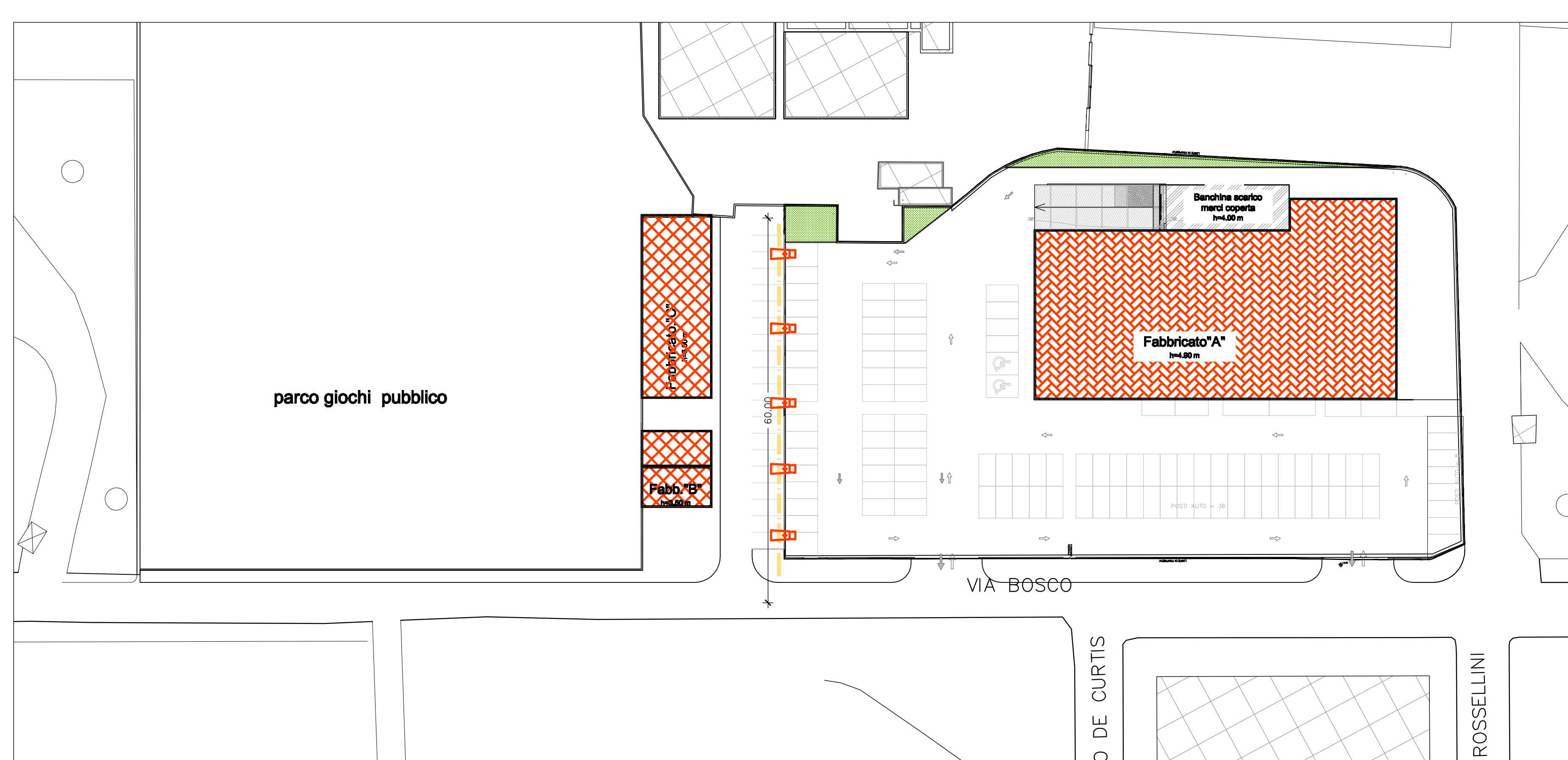
SCHEMA OPERE DI URBANIZZAZIONE PRIMARIA VIA BOSCO RETE ILLUMINAZIONE PUBBLICA - scala 1:500
